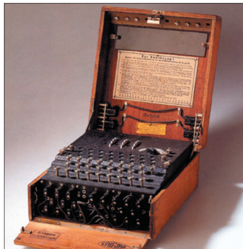
4. Enigma, niemiecka maszyna szyfrująca
