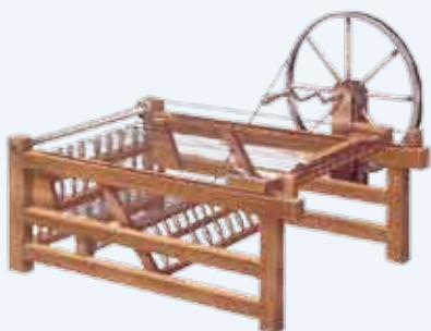
Automatyczna przędzarka – mogła prząść naraz osiem szpilek nici, podczas gdy zwykły kołowrotek prządł w tym czasie tylko jedną nić.
