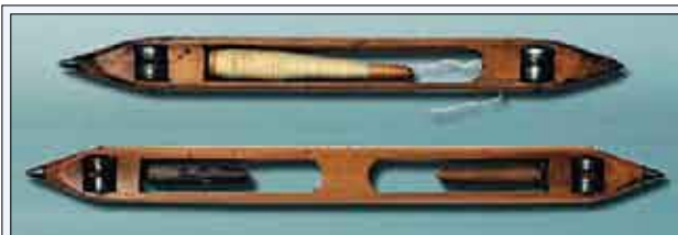
2. „Latające czółenka” – wynalazek angielskiego sukiennika Johna Kaya (czytaj: dżona keja) (1704–1780). Dowiedz się, częścią jakiej maszyny było czółenka
