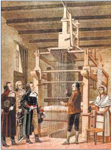
3. Maszyna tkacka Jacquarda (czytaj: żakarda) na XVIII-wiecznej ilustracji
