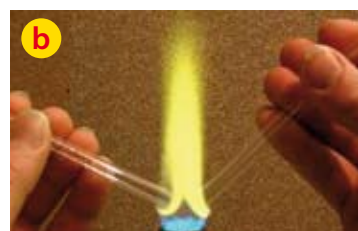
Ryc. 8 Szklana rurka przed wygięciem (a) i po wygięciu (b)
