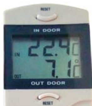
Ryc. 3 Termometr elektroniczny mierzący temperaturę wewnątrz i na zewnątrz pomieszczenia
