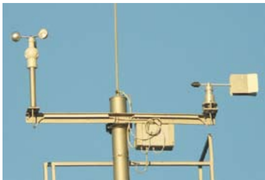
Ryc. 3 Wiatromierz na wieży meteorologicznej. Po lewej stronie wiatraczek mierzący prędkość wiatru, po prawej blaszany wskaźnik kierunku wiatru
