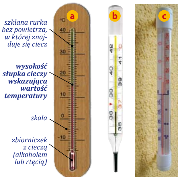
Ryc. 2 Różne rodzaje termometrów cieczowych: pokojowy (a), lekarski (b), zaokienny (c)
